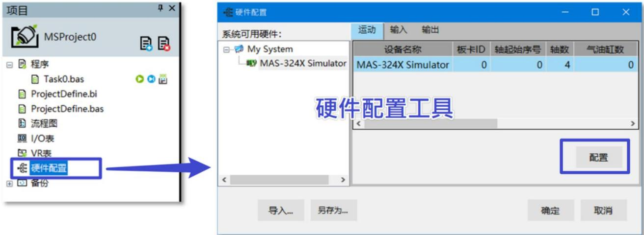
如需要修改硬件参数, 点击[配置]按钮, 会出现下面视窗, 修改您需要修改参数的即可. 修改完成后 IDE 会自动生成配置档, 并下载到 Motion Runtime.
