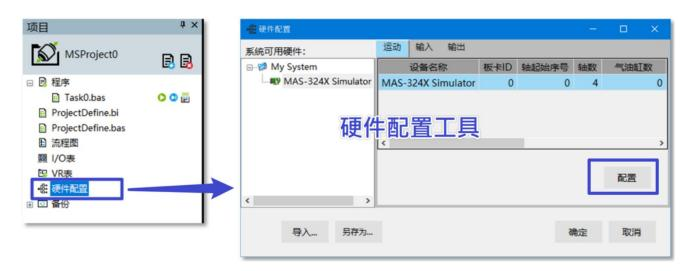
如需要修改硬件参数,点击[配置]按钮,会出现下面视窗,修改您需要修改参数的即可.修改完成后 IDE 会自动生成配置档,并下载到 Motion Runtime.
